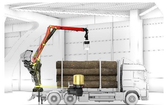
Durch die **manuelle Zentralschmierung** können die wichtigsten Schmierpunkte von einer zentralen Schmierstelle mittels Fettpresse schnell und einfach geschmiert werden.
