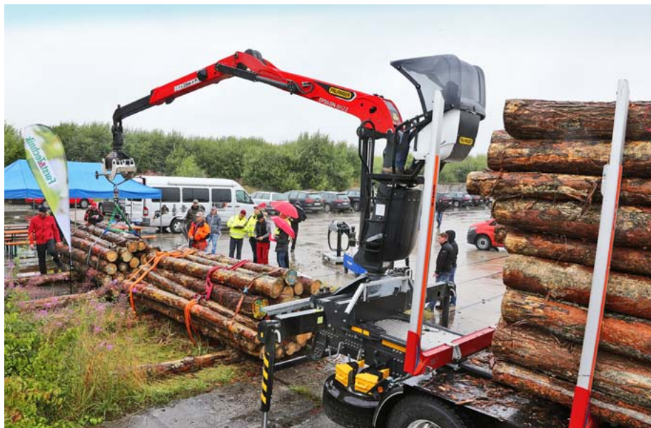
Die Hubkraft wurde bei drei verschiedenen Auslagen gemessen: 3 m, 5 m und 7,5 m
