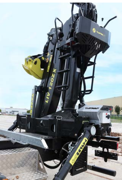
Trotz außenliegender Schläuche an der Kransäule präsentiert sich der LIV 120 ZX sehr aufgeräumt
