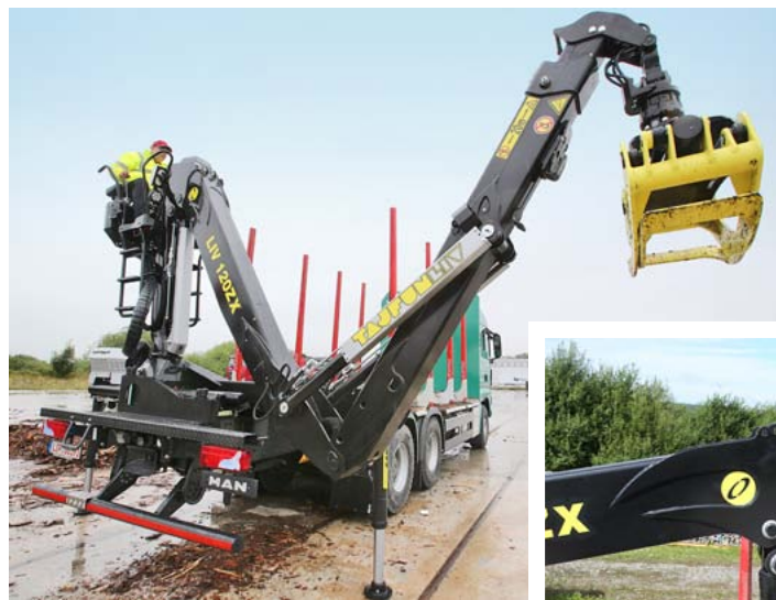
Trotz außenliegender Schläuche an der Kransäule präsentiert sich der LIV 120 ZX sehr aufgeräumt
