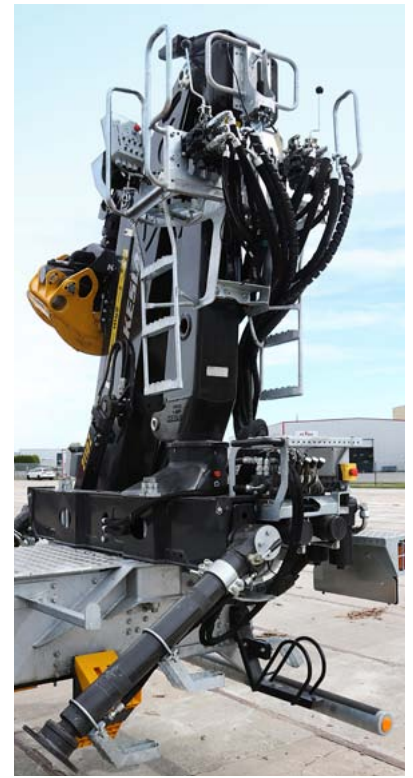
Der Käufer dieses Kesla 2110 Z hat sich nur ganz simple Tritte für den Aufstieg montieren lassen. Diese fanden nicht viel Anklang bei den Testern. Die Verschlauchung ist pragmatisch zweckmäßig
